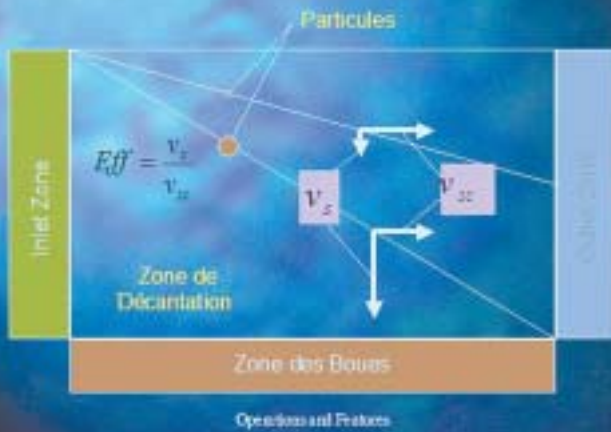
Vitesse de décantation critique
