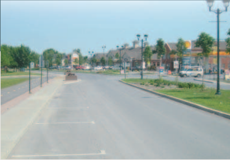
Fig. 3 Utilisation des avancées de trottoir pour protéger les cases de stationnement
