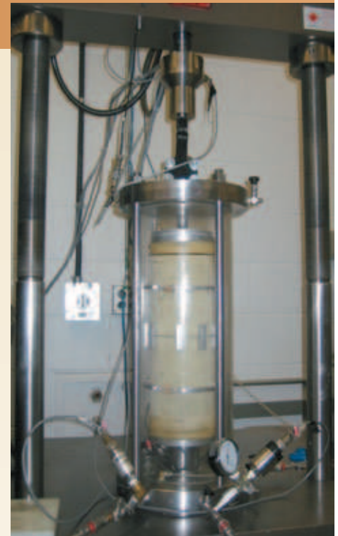
Montage de l'essai triaxial
