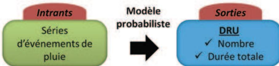
**Figure 1** : Intrants et sorties du modèle probabiliste pour estimer le nombre et la durée totale des DRU, développé pour 30 ouvrages de surverse du Québec.
