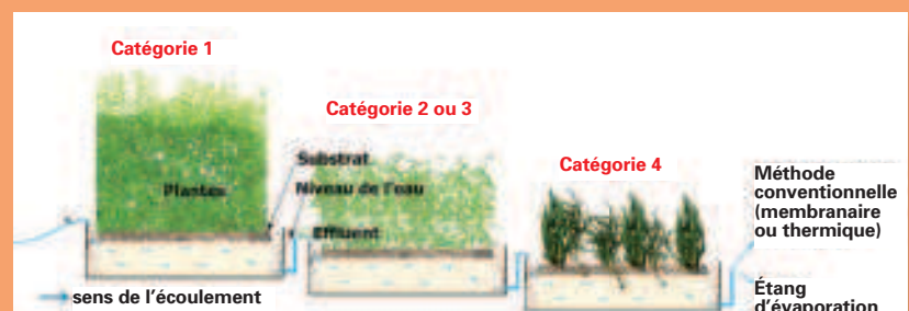
Figure 2 : Schéma d'un système de phytoconcentration
