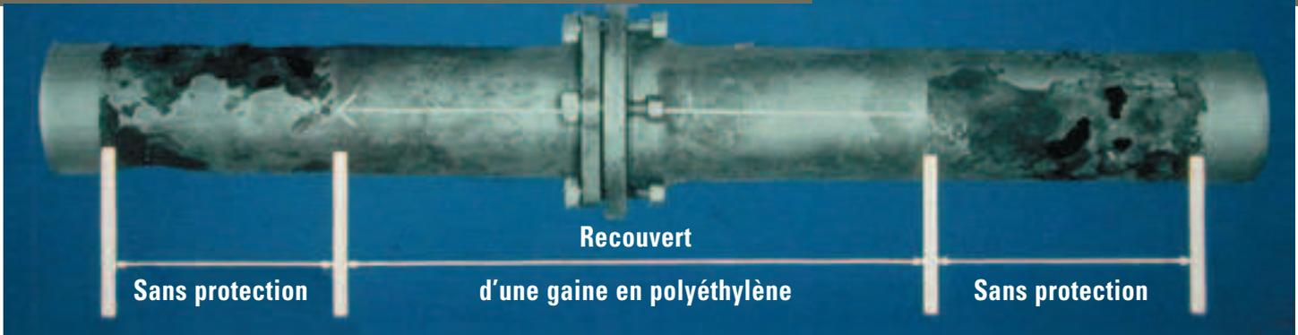
La gaine de polyéthylène empêche que le tuyau ou l'accessoire soit en contact direct avec l'environnement corrosif. Bien que la gaine de polyéthylène ne soit pas un système complètement étanche, cela ne diminue en rien ses propriétés protectrices. Initialement, l'humidité entre la gaine de polyéthylène et la conduite va contenir un pourcentage d'oxygène.
