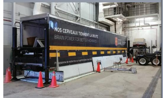
Figure 2 : Simulateur de véhicule lourd
