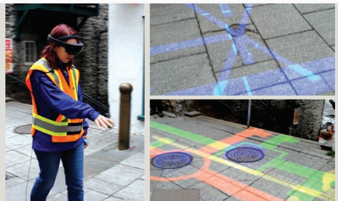
Figure 2 : Plans d'infrastructures souterraines projetés sur la surface de la rue à l'aide du HoloLens de Microsoft.
