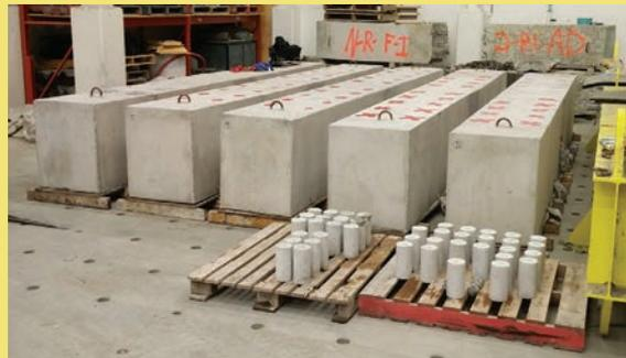
**Figure 5 a: Spécimens de dalle fabriqués à l'Université Laval**
