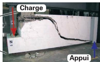
**Figure 1 b :** Rupture en cisaillement d'une tranche de dalle épaisse représentant celle du viaduc de La Concorde (adapté de Johnson et coll., 2007)
