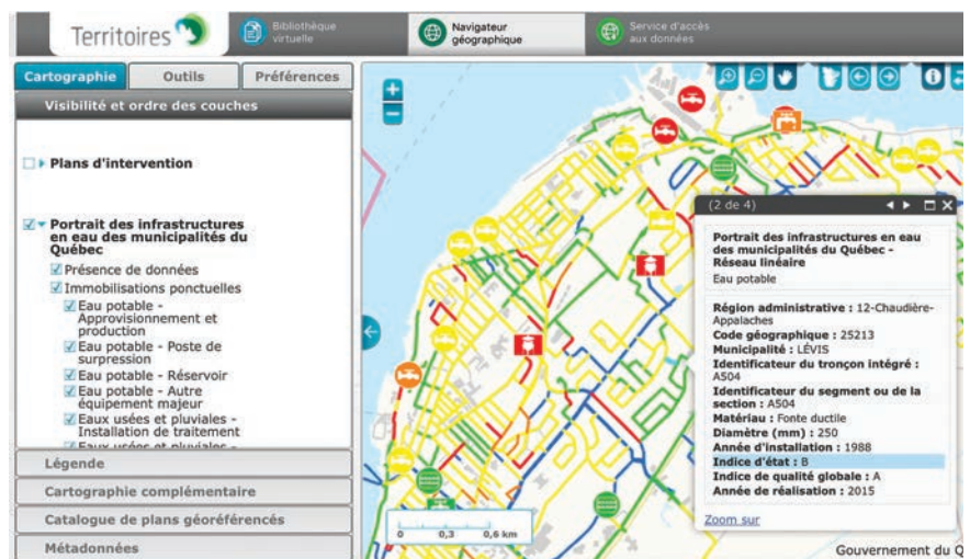
Figure 2: Couche des indices d'état du PIEMQ dans Territoires (réseau d'eau potable)
