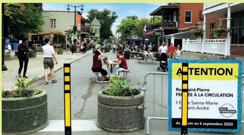
Des corridors piétons temporaires, délimités grâce à des balises flexibles, des butoirs et des pots de fleurs en béton, ont été aménagés dans le Vieux-Terrebonne. Un tronçon de la rue Saint-Pierre a aussi été réservé aux piétons. Une voie de stationnement a aussi été retirée afin de permettre aux restaurateurs d'aménager des terrasses. © Piétons Québec
